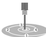
Plonger le bâton dans 4 zones différentes avant de le replacer dans le tube.
